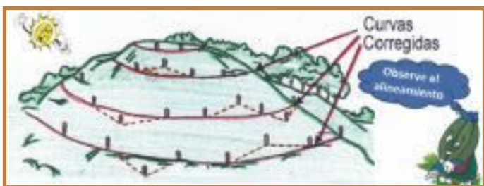
Alineamiento de las estacas en curvas
