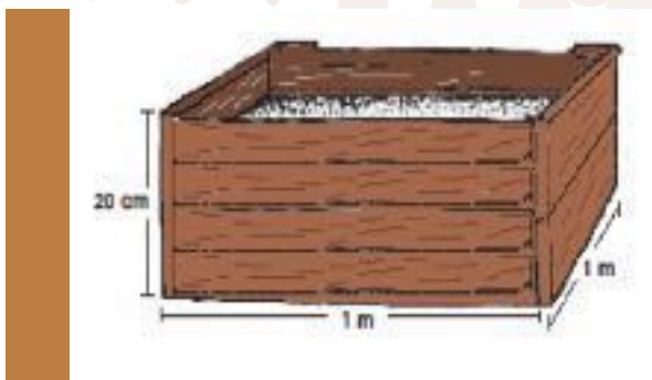
Construcción del cajón germinador
